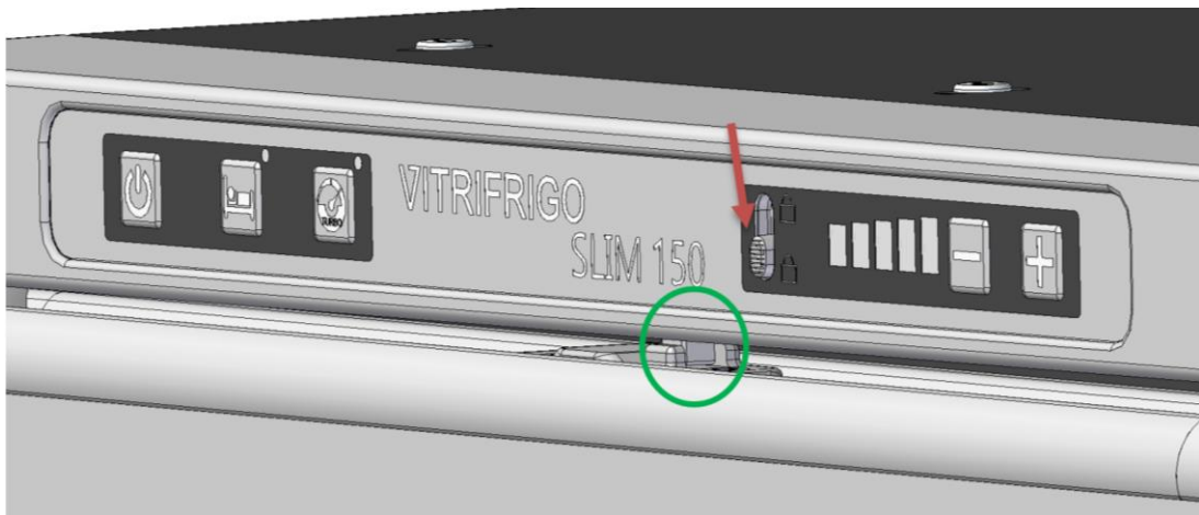
Kühlschrank in Lüftungsposition
