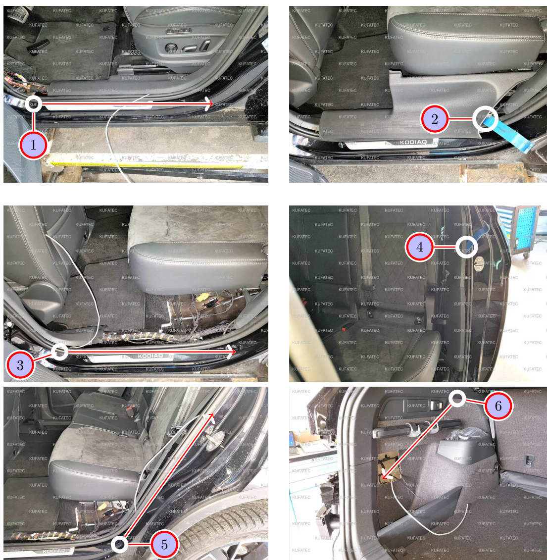
Abbildung 7: Leitungsverlegung zum Geräuscherzeuger
